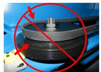
Pour bien tendre la courroie, utilisez une pression de 10 lbs ou appliquez une pression manuelle sur la courroie.
