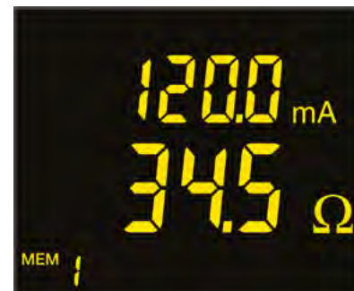
Mode standard : Impédance et courant de fuite
