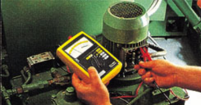
Contrôle de l'isolement des enroulements d'un moteur.
