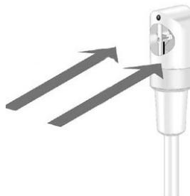
La valeur correcte est déterminée en tournant légèrement la sonde dans un sens et dans l'autre, jusqu'à ce que la valeur maximale soit affichée.
